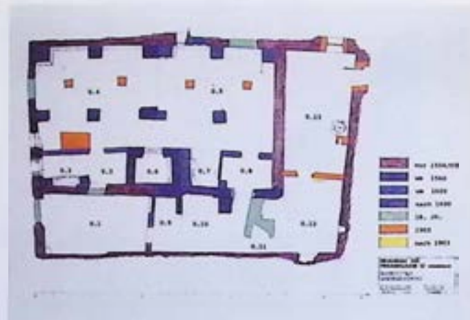
Die tieferen Sinnschichten des Denkmals erschließen sich erst durch die Bereitschaft zu intensiver Auseinandersetzung. Die Bauforschung läßt Funktionsstruktur und Entwicklungsgeschichte des Badhauses erkennen. Im Untergeschoß ist die große Badstube mit den Nebeneinrichtungen wie Feuerungsstätten, Kesselraum etc. zu erkennen.
